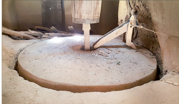
گندم‌ها از حفره میانی ریخته می‌شوند و آرد‌ها از کناره سنگ بیرون می‌آیند
