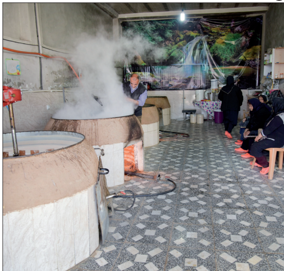
فرآوری شیرابه‌های نیشکر با جوشاندن در دیگ‌های مسی برگ‌ها از ساقه نیشکر جدا می‌شود تا ساقه‌ها آماده استحصال بشوند
